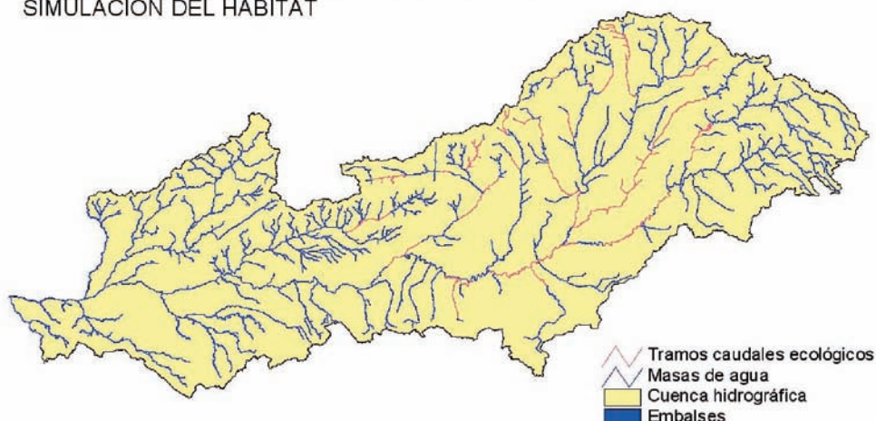
Figura 3. Tramos de la cuenca del Tajo en el que se han estimado caudales ecológicos por métodos de simulación de Hábitat. Elaboración propia.
