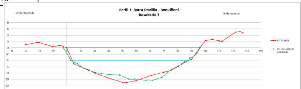
Figura 54. Perfil transversal al lado del embarcadero.
